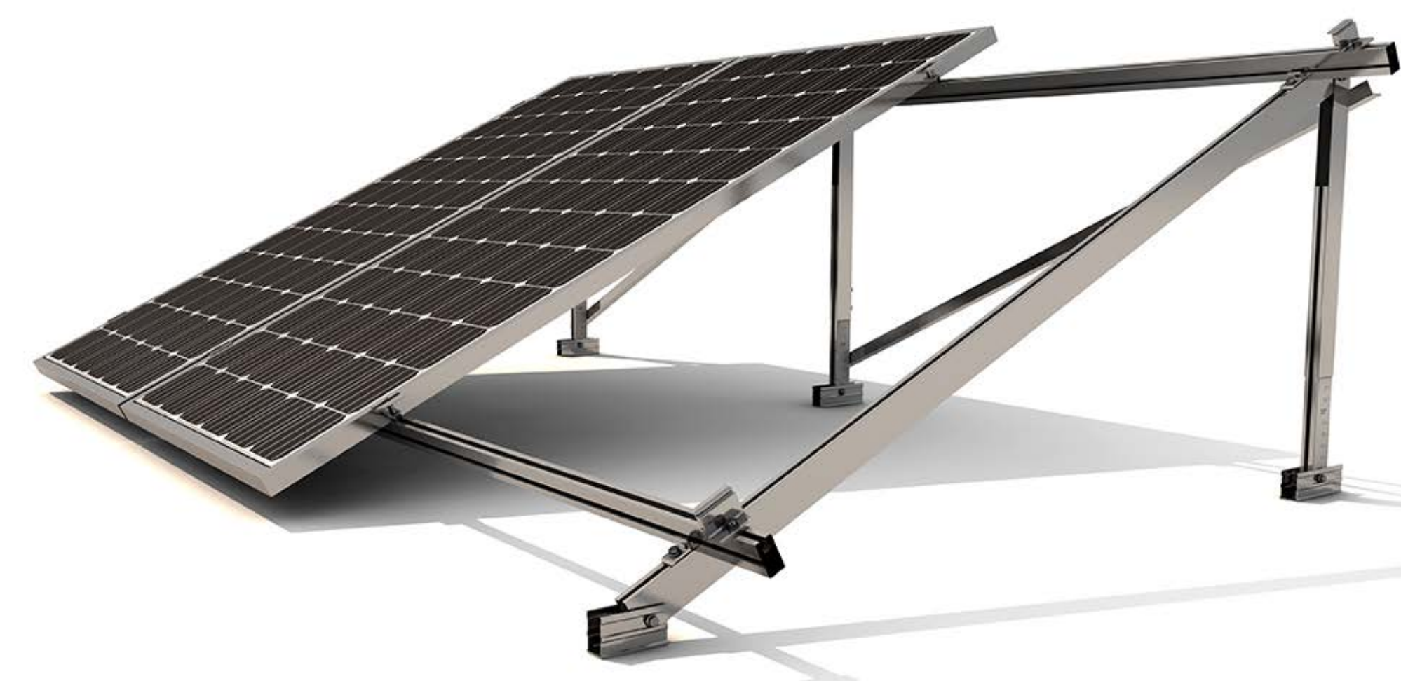
Instalación en cubierta de chapa. Todos los puntos de anclaje del triángulo deben siempre anclarse a la correa de la cubierta. En caso contrario se deberá colocar una subestructura. Consultar apartado de subestructuras de este catálogo.
